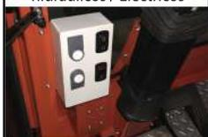
Cuadro de instrumentos del sistema Hidráulico / Eléctrico accesible desde el interior de la cabina
